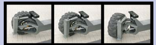
Het 4-weg besturingssysteem transformeert de meeneemheftruck tot een geavanceerde zijlader.
