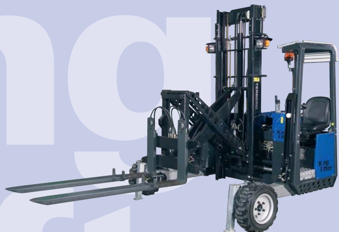
Het 4-weg besturingssysteem transformeert de meeneemheftruck tot een geavanceerde zijlader.
